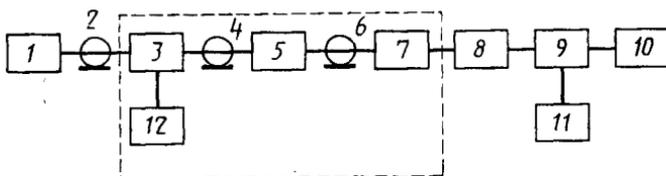
1—измерительный генератор; 2, 4, 6—коаксиальный кабель; 3—коаксиальный переключатель; 5—фильтр; 7—согласующее устройство; 8—коаксиальный соединитель; 9—коаксиальный измерительный соединитель-тройник (например элемент № 11—1 из комплекта вольтметра типа ВЗ—24); 10—веряемый вольтметр; 11—образцовый вольтметр; 12—нагрузочный резистор
