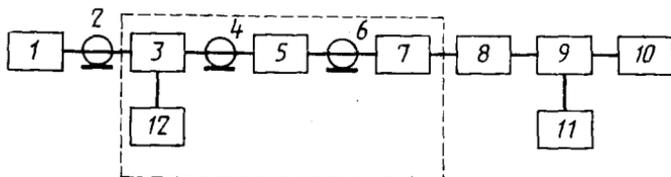
1—измерительный генератор; 2, 4, 6—коаксиальный кабель; 3—коаксиальный переключатель; 5—фильтр; 7—согласующее устройство; 8—коаксиальный соединитель; 9—образцовый делитель напряжения; 10—веряемый вольтметр; 11—образцовый вольтметр; 12—нагрузочный резистор
